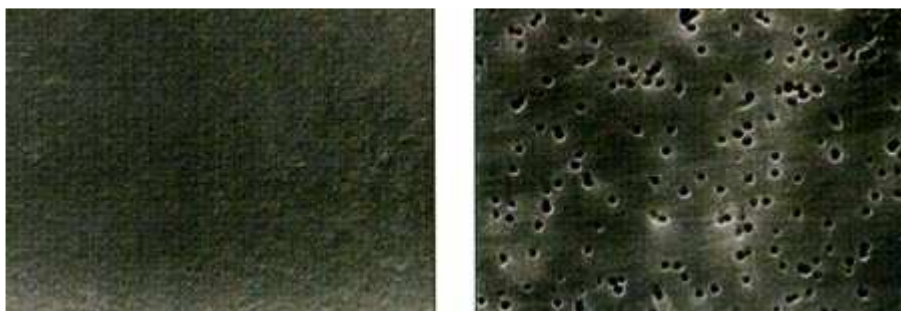
Εικόνα 6. Σύγκριση πόρων αντίστροφης όσμωσης και μικροφίλτρου
