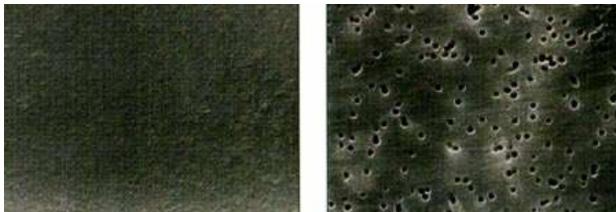
Εικόνα 6. Σύγκριση πόρων αντίστροφης όσμωσης και μικροφίλτρου
